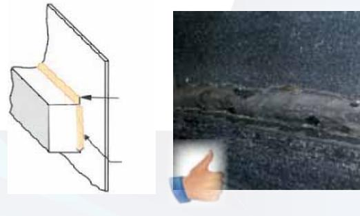
Le laitier et les projections de soudure doivent être éliminés. Les produits destinés à empêcher l'adhérence de projections (anti gratons) doivent être exempts de silicones qui nuiraient à la mise en peinture et une préparation de surface adéquate (chimique ou mécanique) doit être réalisée sur ces anti-adhérents.
