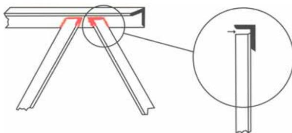
Les soudures réalisées après galvanisation doivent être, le cas échéant, traitées et "reconditionnées".
